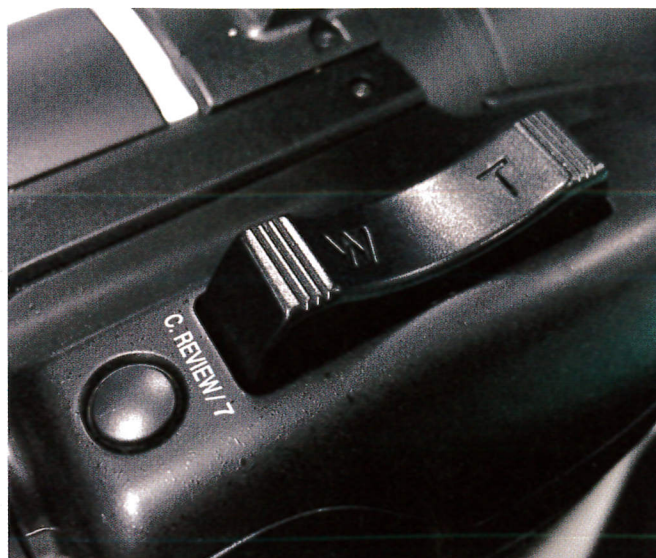
Il bilanciamento dello zoom sopra l'impugnatura destra non è l'unico (ce n'è uno anche sul manico superiore). Il tasto Clip Review può essere anche personalizzato dall'operatore con una funzione a scelta.
